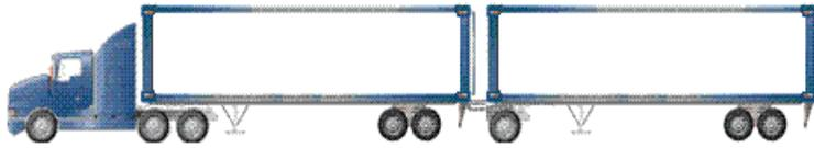
Tractocamión 3 ejes, semirremolque 2 ejes remolque 4 ejes y tractocamión 3 ejes, semirremolque 2 ejes remolque 3 ejes. Full, configuración carga seca.
